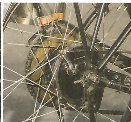
Bemerkenswert: Berwald verschrieb seinen Hermes vorn wie hinten große Bremsen!
