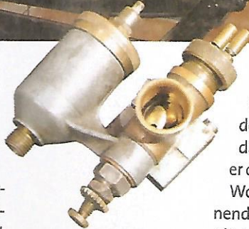
Marke Eigenbau: Der beim Kauf montierte Vergaser war unter anderem aus einem Wasserrohrkreuz entstanden!
