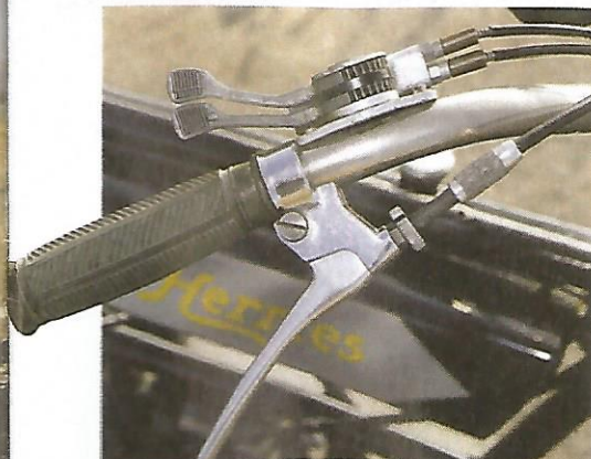
Ein Hebel fürs Gas, einer für die Luft – die richtige Bedienung in allen Lastzuständen will gelernt sein
