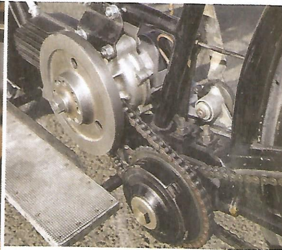
Entscheidender Fortschritt: Nur die letzten Hermes hatten eine Kupplung und ein Dreiganggetriebe
